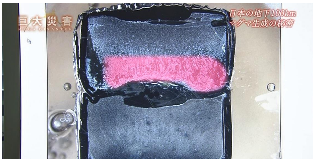
(マグマ生成の秘密 ピンクの部分が溶解してマグマ化している)
